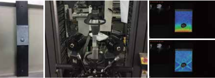
碳纤维连接件拉伸实验
